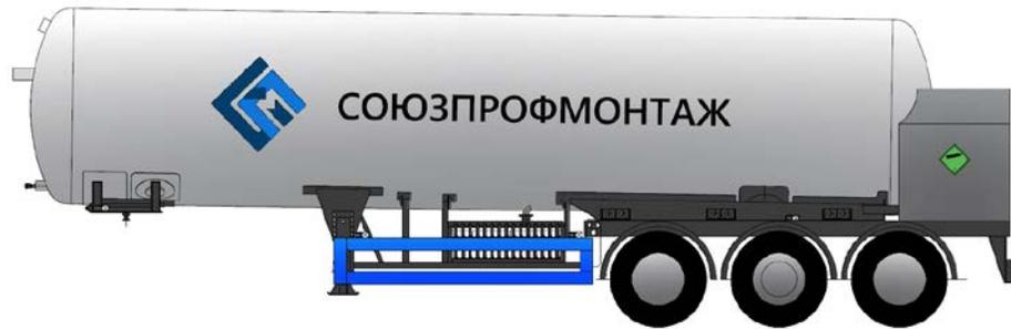
ООО «Союзпрофмонтаж» предлагает Вам продукцию собственного производства полуприцепы-цистерны транспортные криогенные предназначенные для транспортировки/перевозки и кратковременного хранения сжиженных углеводородных газов СУГ (метан  $CH_4$ , этан  $C_2H_6$  и этилена  $C_2H_4$ ), далее «ППЦТК\_LG».
