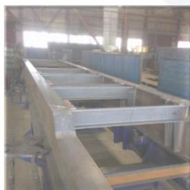
Сварка рамы шасси полуприцепа-цистерны
