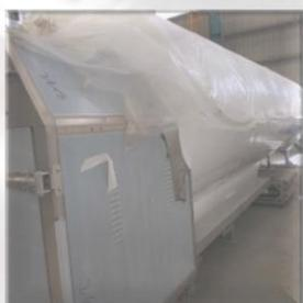
Цистерна изотермическая без шасси
