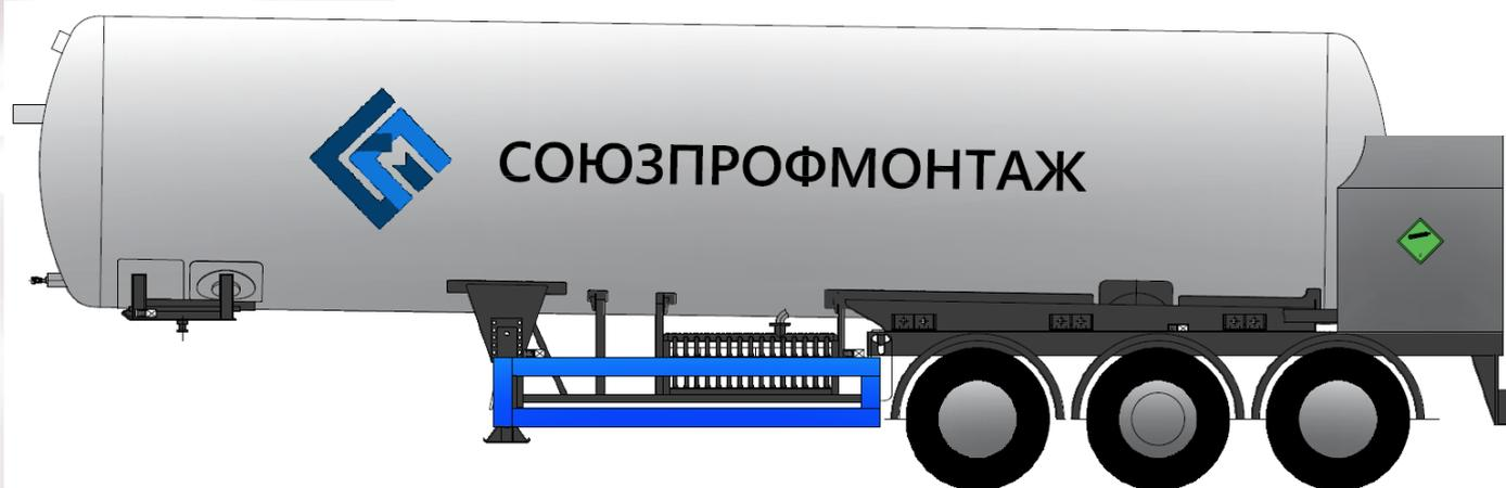
ООО «Союзпрофмонтаж» предлагает Вам продукцию собственного производства полуприцепы-цистерны транспортные криогенные предназначенные для транспортировки/перевозки и кратковременного хранения сжиженных углеводородных газов СУГ (метан  $CH_4$ , этан  $C_2H_6$  и этилена  $C_2H_4$ ), далее «ППЦТК\_LG».
